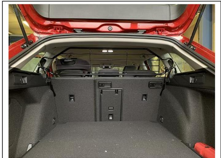
Trenngitter im montierten Zustand.
