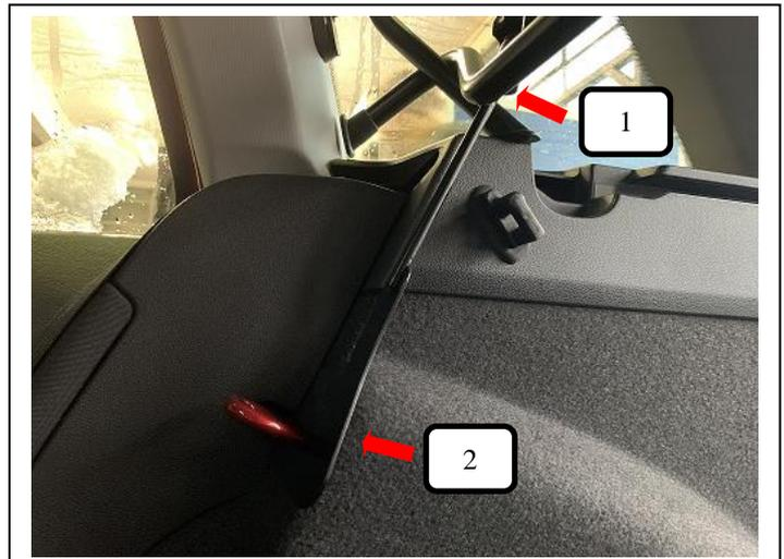
Trenngitter (Pos. 1) von hinten aus in das Fahrzeug einbringen und an der C-Säule positionieren, Gewindehaken (Pos. 2) von unten in die Rücksitzbankarretierung einhängen und oben durch das Trenngitter (Pos. 1) schieben.
