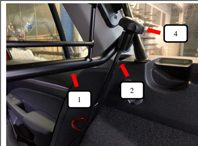
Rändelmutter (Pos. 4) auf den Gewindehaken (Pos. 2) aufschrauben und festziehen. Nur so fest anziehen, bis das Trenngitter (Pos. 1) spielfrei sitzt.
