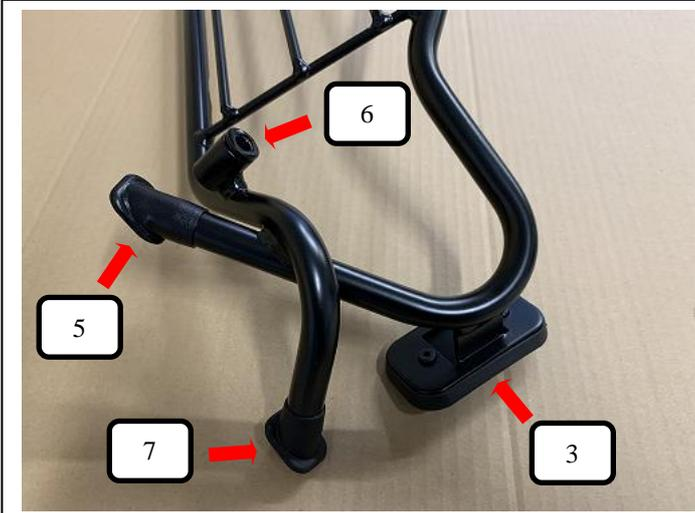
Gummiauflage groß (Pos. 3), Gummifuß 45° (Pos. 5) und Gummifuß 25° (Pos. 7) auf das Trenngitter und Kunststoffhülse (Pos. 6) in das Trenngitter stecken.
