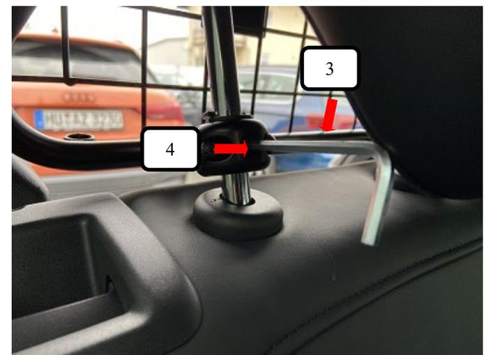
Mit dem Inbusschlüssel (Pos. 3) die mittlere Schraube in der Halbschale (Pos. 4) reindrehen und festziehen.
