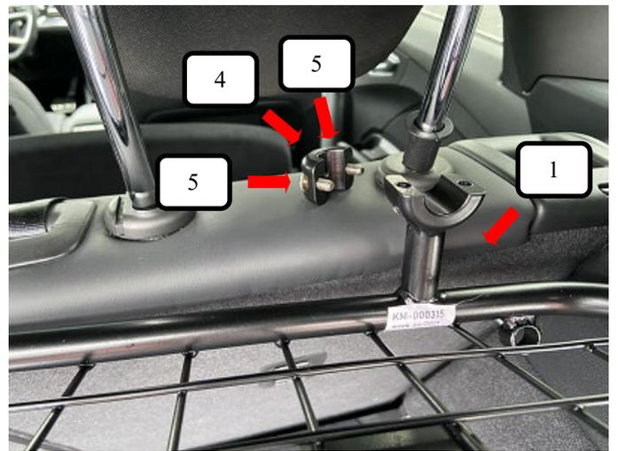
Durch die Halbschale (Pos. 4) zwei Inbusschrauben (Pos. 5) stecken, jetzt das Trenngitter (Pos. 1) und die halbschale (Pos. 4) aneinanderhalten.
