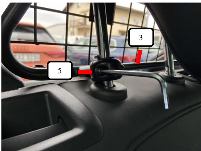
Mit dem Inbusschlüssel (Pos. 3) die Inbusschraube (Pos. 5) rechts und links festziehen.
