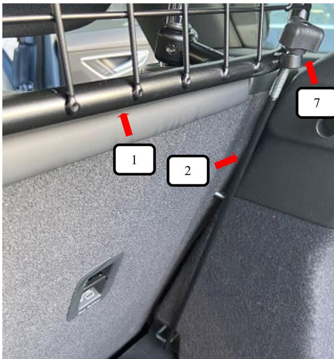
Gewindehaken (Pos. 2) unten in die Verzurröse einhängen und durch die Metallöse am Trenngitter (Pos. 1) führen, Jetzt eine Rändelmutter flach (Pos. 7) aufschrauben und festziehen.
