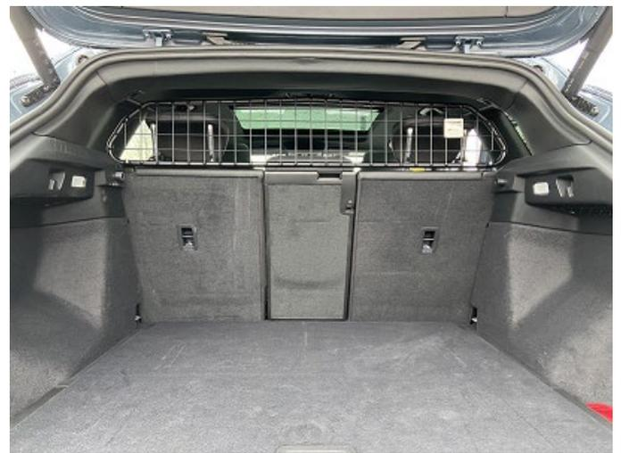
Trenngitter im montierten Zustand.
