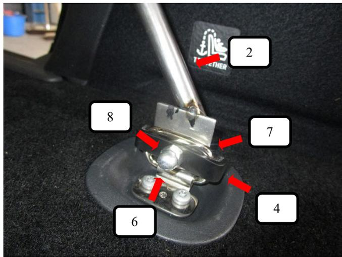
Stützstrebe rechts + links (Pos. 2) wie auf dem Bild von außen an die hochgeklappte Verzurröse halten, von außen jetzt die Rundkopfschraube (Pos. 7) durchstecken. Nun von der anderen Seite den U-Bügel (Pos. 4), Unterlegscheibe (Pos. 8) und Hutmutter M8 (Pos. 6) aufschrauben und festziehen.
