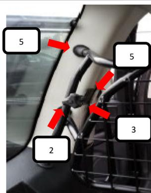
Gewindehaken durch die Kunststoffhülsen (Pos.3) am Trenngitter stecken und mit der Rändelmutter (Pos.2) leicht befestigen. Trenngitter (Pos.1) sowie Schutzkappen (6x Pos.5) ggf. so ausrichten, dass eine Plananlage auf den Flächen gewährleistet ist. Nun die Rändelmutter (Pos.2) am Gewindehaken (Pos.4) anziehen.
