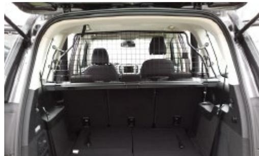
Trenngitter im montierten Zustand.
