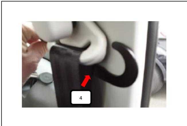
Gewindehaken (Pos. 4) jeweils auf der rechten und linken Seite des Fahrzeuges von unten an der Halterung des Sicherheitsgurtes einhängen.
