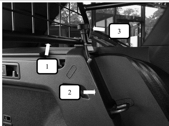
Jetzt die Rändelmutter gewölbt (Pos. 3) auf die Gewindestange (Pos. 2) aufschrauben und festziehen.
