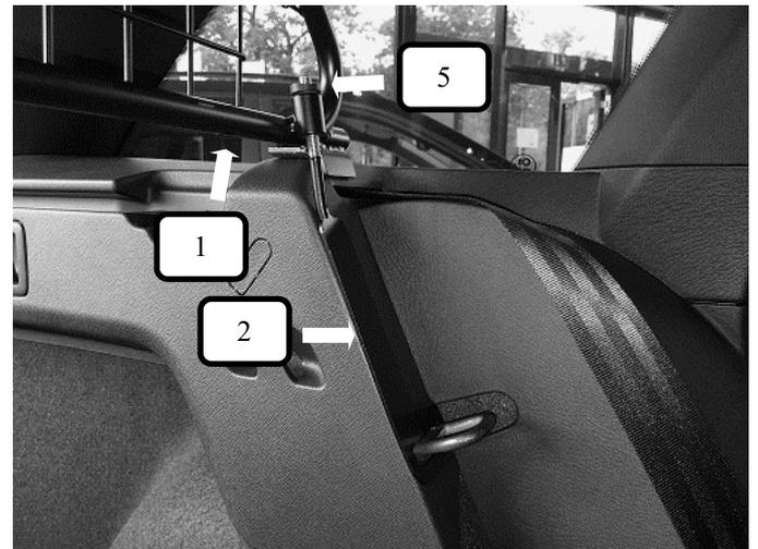
Gewindehaken (Pos. 2) wie auf dem Bild über die Rücksitzbankarretierung führen und dann durch das Trenngitter (Pos. 1) sowie Kunststoffhülse (Pos. 5) stecken.
