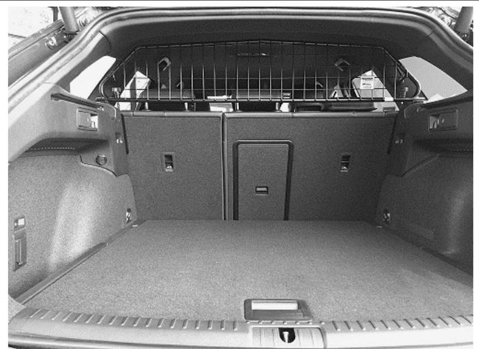
Trenngitter im montierten Zustand.
