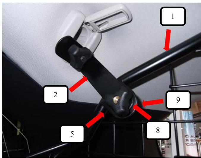
Trenngitter (Pos. 1) oben an den Dachhaltern (Pos. 2) rechts und links aus Bild 3 mittels Schlossschraube (Pos. 9), Unterlegscheibe (Pos. 8) und Rändelmutter flach (Pos. 5) leicht befestigen.
