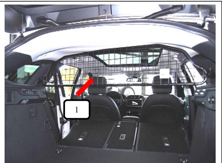
Trenngitter (Pos. 1) schräg von vorne nach hinten, hinter die C-Säule einführen.
