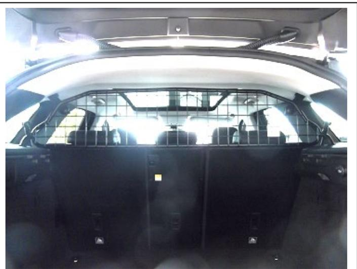
Trenngitter im fertig montierten Zustand.
