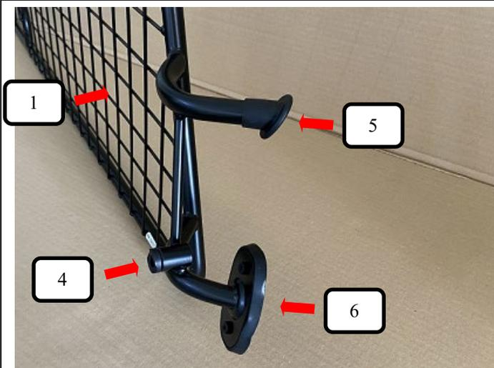
Gummifuß 25° (Pos. 5) sowie Gummiauflage groß (Pos. 6) auf das Trenngitter (Pos. 1) und Kunststoffhülse (Pos. 4) in das Trenngitter (Pos. 1) wie auf dem Bild stecken.
