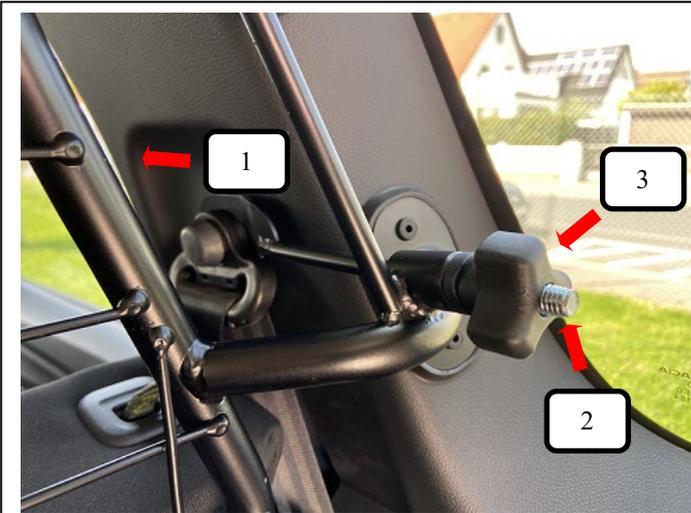
Jetzt auf beiden Seiten eine Rändelmutter gewölbt (Pos. 3) auf die Gewindestangen L+R aufschrauben und festziehen.
