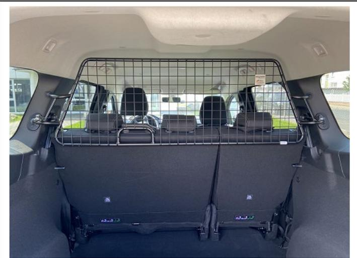
Trenngitter im montierten Zustand.
