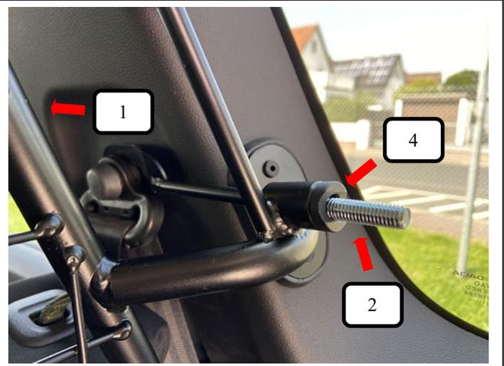
Trenngitter (Pos. 1) in das Fahrzeug einbringen und an der C-Säule platzieren. Jetzt den Gewindehaken L+R (Pos. 2) auf beiden Seiten in die Gutverankerung einhängen und durch die Kunststoffhülse (Pos. 4) sowie Trenngitter (Pos. 1) schieben.
