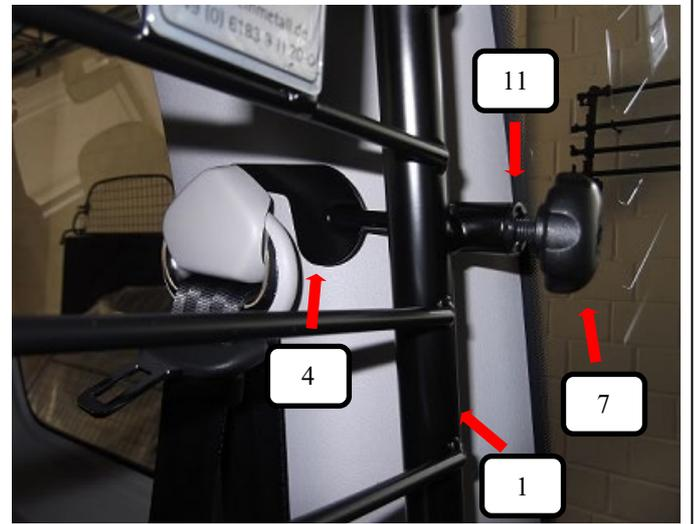
Gewindehaken M8 (Pos. 4) über den Gurtlenkpunkt einhaken und durch die Kunststoffhülse (Pos. 11) im Trenngitter (Pos. 1) führen, jetzt die Rändelmutter M8 (Pos. 7) darauf drehen und anziehen. Die Schutzkappen (Pos. 12) auf die eventuell herausschauenden Gewinde stecken.
