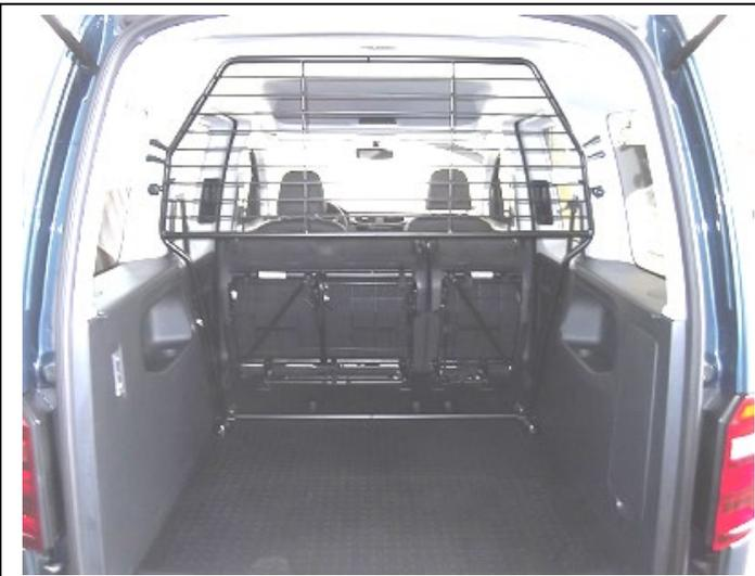
Trenngitter (Pos. 1) im montierten Zustand, bei vorgeklappten Rücksitzen.
