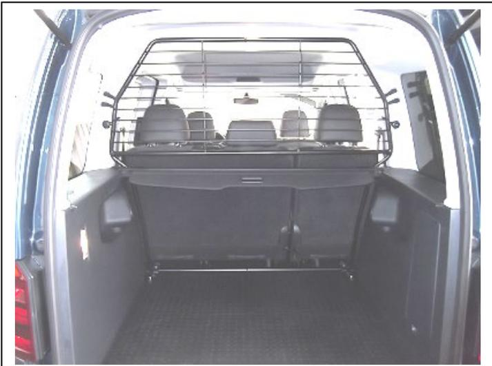
Trenngitter (Pos. 1) im montierten Zustand, mit Abdeckrollo.
