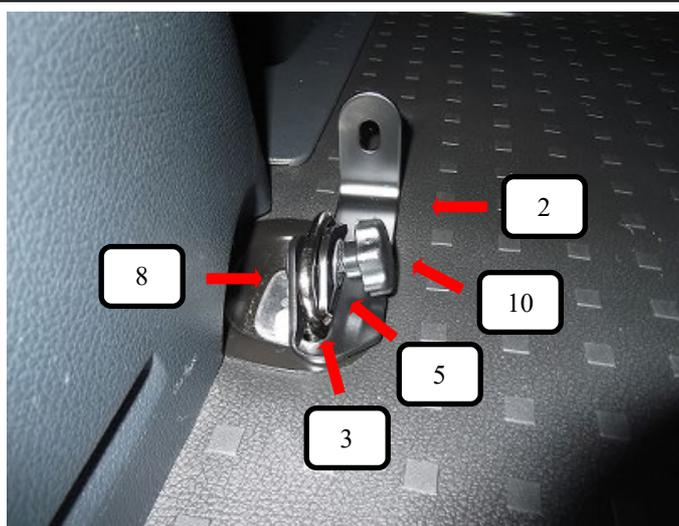
Verzurrösen hochklappen und die Ankerplatte rechts und links (Pos. 2) darüber stecken. Mit den Gegenplatten (Pos. 3), Rundkopfschrauben M8x25 (Pos. 6), Unterlegscheibe (Pos. 5) und Rändelmutter M8 klein (Pos. 10) verschrauben.
