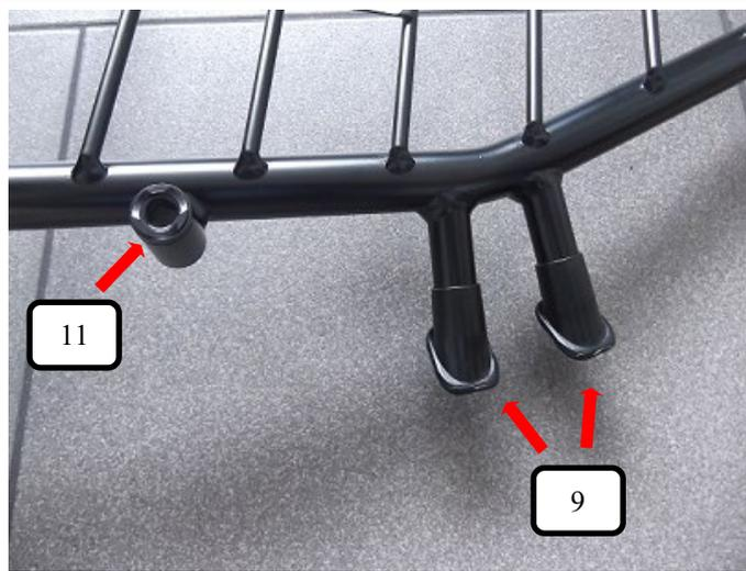
Kunststoffhülse (Pos. 11) rechts und links in das Trenngitter (Pos. 1) und Kunststoffkappen 45° (Pos. 9) auf das Trenngitter (Pos. 1) stecken.
