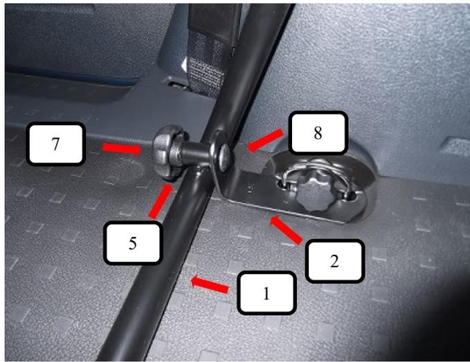
Ankerplatten (Pos. 2) mit den Rundkopfschrauben M8x45 (Pos. 8), Unterlegscheiben (Pos. 5) und Rändelmutter M8 (Pos. 7) am Trenngitter (Pos. 1) verschrauben.
