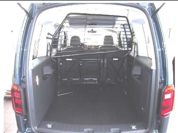
Das Trenngitter (Pos. 1) von hinten schräg in das Fahrzeug einbringen (siehe Bild 4) und hinter der C-Säule platzieren.
