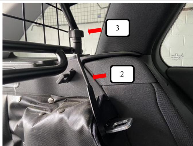
Jetzt die Rändelmutter gewölbt (Pos. 3) auf den Gewindehaken L+R (Pos. 2) aufschrauben und festziehen.
