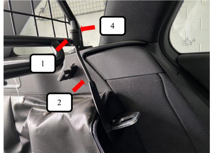
Trenngitter (Pos. 1) in das Fahrzeug einbringen und hinter der C-Säule platzieren. Jetzt die Gewindehaken L+R (Pos. 2) in die Rücksitzbankverankerung einhängen und mit dem Gewinde durch die Kunststoffhülse (Pos. 4) und Trenngitter (Pos. 1) führen.
