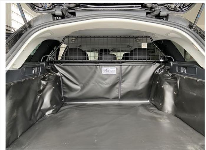
Trenngitter im montierten Zustand.
