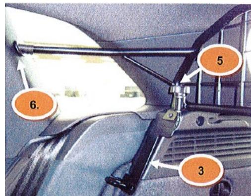
Die Schutzkappen (Pos. 6) an der C-Säule ausrichten. Gewindehaken (Pos. 3) durch die Hülsen am Trenngitter stecken und in die Rücklehne Verankerung einhängen. Rändelmutter (Pos. 2) aufschrauben und festziehen.
