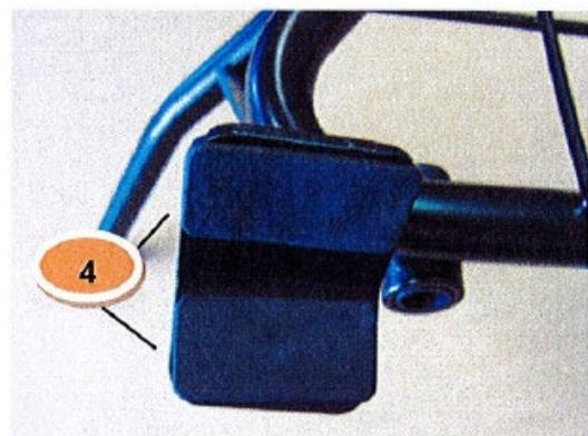
Gummiauflagen (Pos. 4) auf beiden Seiten auf das Trenngitter stecken.
