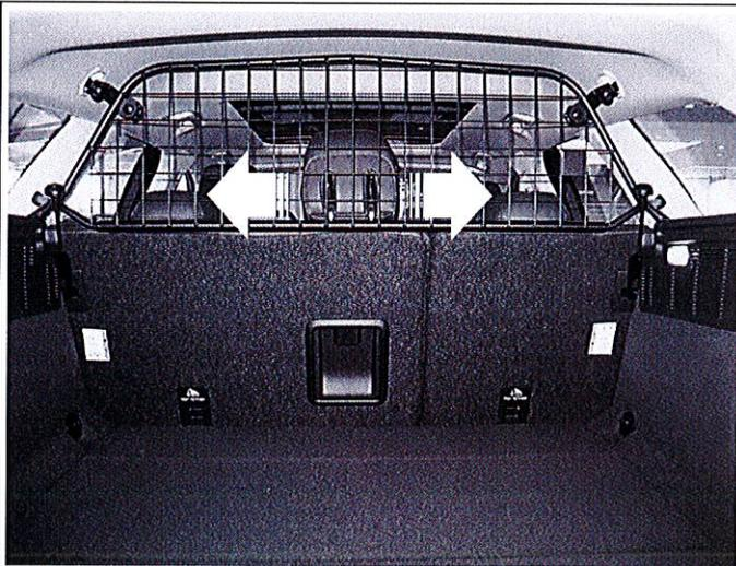
Trenngitter gleichmäßig ausrichten, und Rändelschrauben anziehen bis Trenngitter spielfrei sitzt. Vor dem Einrasten der Rückenlehne entscheiden, ob die mittlere Kopfstütze aufgestellt sein soll. Nach dem Einrasten ist das nicht möglich.
