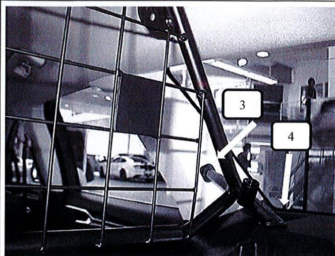
Trenngitter in das Fahrzeug einbringen, und Schutzkappen Pos. 3 & 4 so drehen, dass sie gleichmäßig an den Verkleidungen anliegen.
