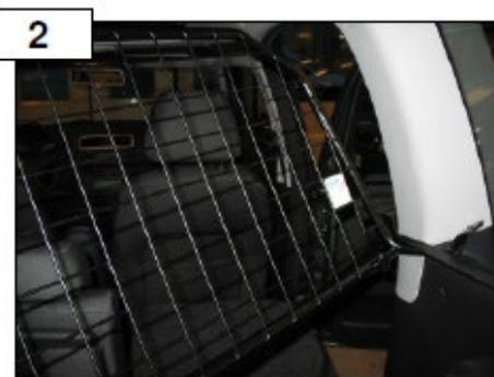
Trenngitter (Pos. 1) in das Fahrzeug einbringen und hinter der C-Säule positionieren.
