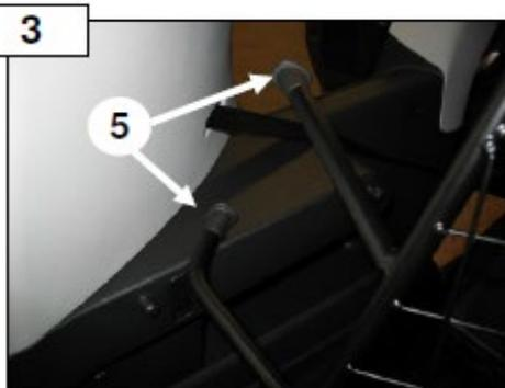
Schutzkappen (Pos. 5) so drehen, dass sie gleichmäßig an den Verkleidungen anliegen.
