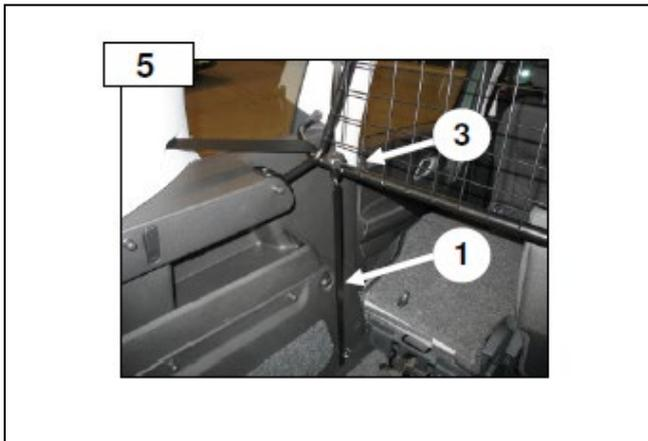
Gewindehaken (Pos. 2) in die vorderen Ladehaken vom Fahrzeug einhaken und mit dem Gewindeabschnitt durch die Kunststoffhülse (Pos. 3) führen. Rändelmutter (Pos. 4) aufschrauben und nur so festziehen, bis Trenngitter spielfrei sitzt.
