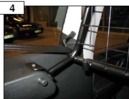
Die Gurte über die untere Strebe am Trenngitter (Pos. 1) führen.
