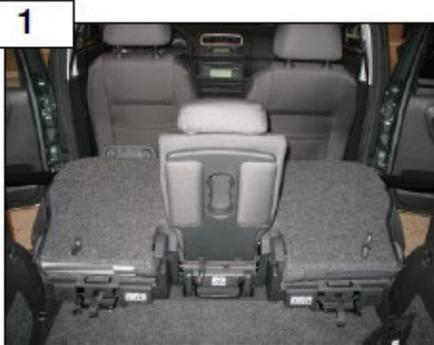
Rücksitze umlegen, Schutzkappen (Pos. 5) auf die Rohrenden stecken. Schutzauflage (Pos. 6) von unten auf die hinteren gebogenen Auflagefüße stecken. Je eine Kunststoffhülse (Pos. 3) von oben in die Hülsen am Trenngitter (Pos. 1) stecken.
