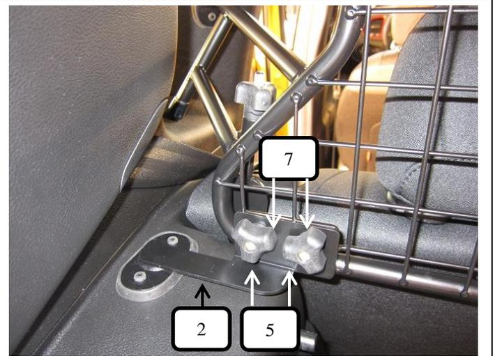
Nun die beiden Stützfüße (Pos.2) der jeweiligen Einbauseite li/re an den am Trenngitter befindlichen Schrauben mit jeweils einer Unterlegscheibe (Pos.7) sowie Rändelmutter flach (Pos.5) lose befestigen.
