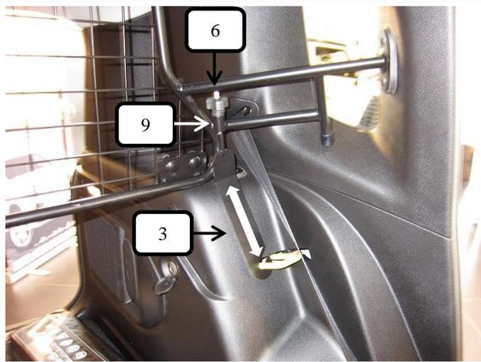
Trenngitter wahlweise vom Kofferraum oder Rücksitzbank ins Fahrzeug einbringen und zwischen den beiden C - Säulen wie im Bild dargestellt positionieren.
