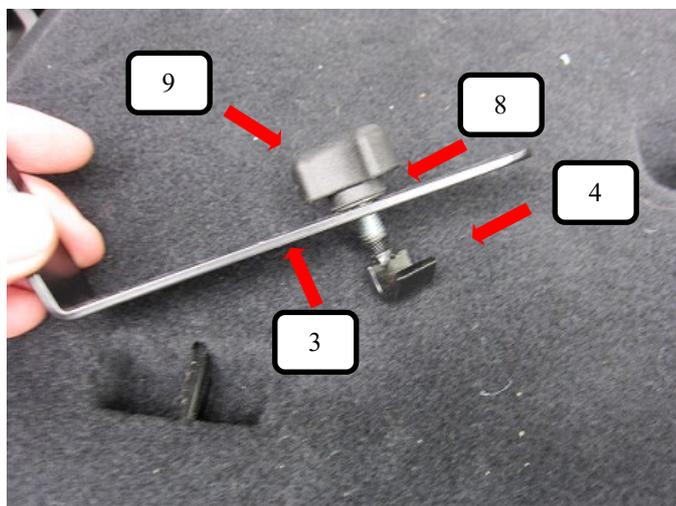
Winkel Boden (Pos.3), Gewindehaken (Pos.4), Unterlegscheibe (Pos.8) und Rändelmutter (Pos.9) vormontieren und einhängen.
