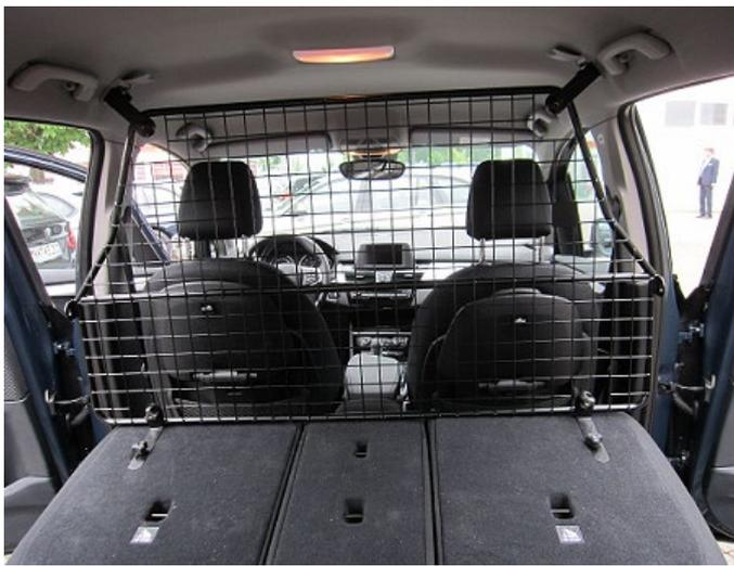
Trenngitter (Pos.1) im montierten Zustand.
