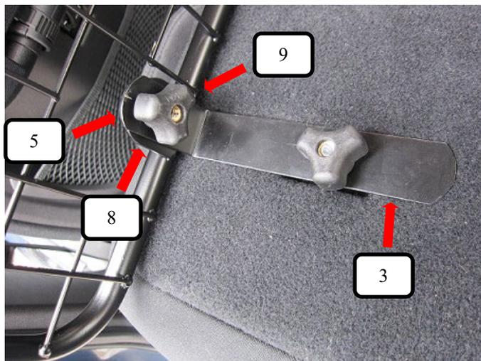
Trenngitter (Pos.1) in das Fahrzeug führen und vor den Winkel Boden (Pos.3) + Winkel Himmel (Pos.2) stellen, dann von vorne die Rundkopfschraube (Pos.5) durch das Trenngitter (Pos.1) und den Winkel Boden (Pos.3) stecken. Jetzt die Unterlegscheibe (Pos.8) und mit der Rändelmutter (Pos.9) fest schrauben.
