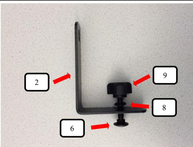
Winkel Himmel (Pos.2), Rundkopfschraube (Pos.6), Unterlegscheibe (Pos.8) und Rändelmutter (Pos.9) wie auf dem Bild vormontieren.
