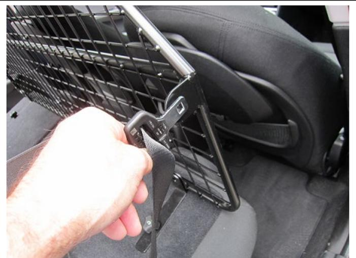
Zusätzliche Sicherung: Den Gurt nach vorne ziehen und mit der Rundkopfschraube (Pos.7) und der Knebelmutter (Pos.10) am Trenngitter (Pos.1) befestigen.
