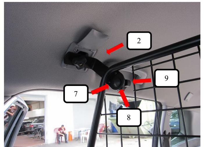
Jetzt den Winkel Himmel (Pos.2) mit der Rundkopfschraube (Pos.7), Unterlegscheibe (Pos.8) und der Rändelmutter (Pos.9) montieren.
