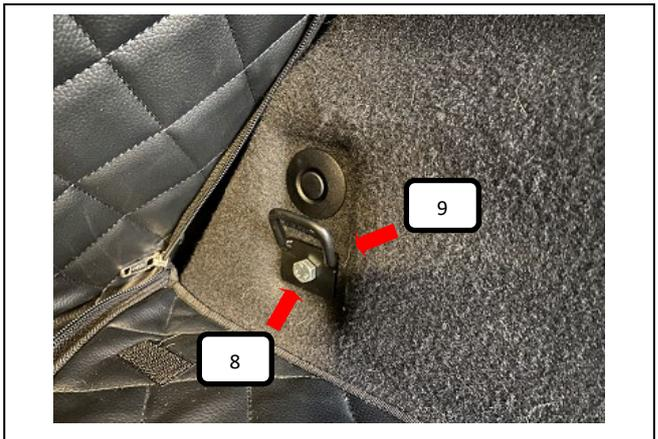
Untere Original-Kunststoffabdeckung entfernen, jetzt die Verzurröse (Pos. 9) mit der Sechskantschraube (Pos. 8) anschrauben.
