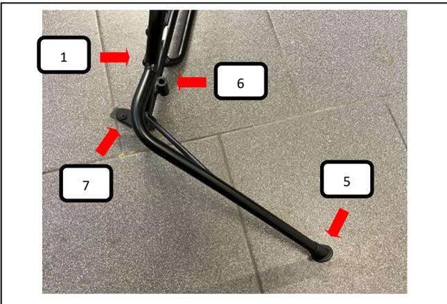
Kunststoffhülsen (Pos. 6) in das Trenngitter (Pos. 1) und Gummiauflage klein (Pos. 7) sowie Gummifuß 25° (Pos. 5) auf das Trenngitter (Pos. 1) stecken.
