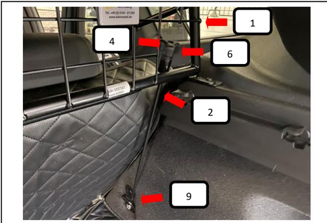
Gewindestange (Pos. 2) in die Verzurröse (Pos. 9) einhängen und dann nach oben durch das Trenngitter (Pos. 1) und Kunststoffhülse (Pos. 6) führen. Jetzt die Rändelmutter gewölbt (Pos. 4) aufschrauben und festziehen.
