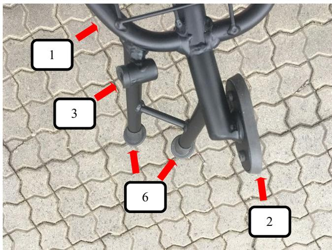
Vor dem Einbringen in das Fahrzeug, Kunststoffhülse (Pos. 3) in das Trenngitter (Pos. 1) und Schutzkappe 25° (Pos. 6) sowie Gummiauflage groß (Pos. 2) auf das Trenngitter (Pos. 1) stecken.
