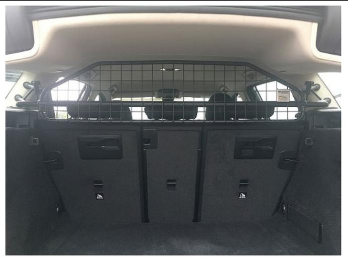
Trenngitter im montierten Zustand.
