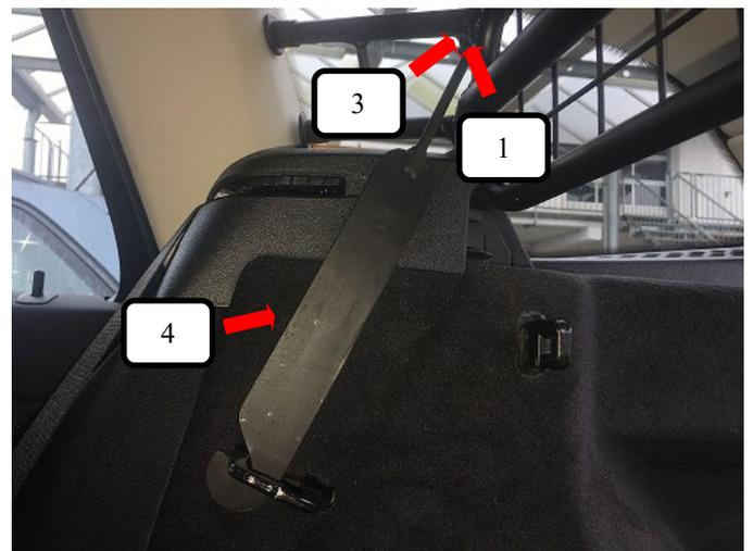
Trenngitter (Pos. 1) in das Fahrzeug einbringen und wie auf dem Bild an der C-Säule positionieren. Gewindehaken (Pos. 4) in die Rücksitzbankverankerung einhängen und nach oben durch das Trenngitter (Pos. 1) und Kunststoffhülse (Pos. 3) durchführen.
