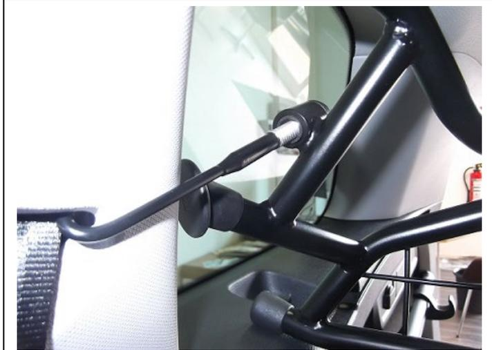
Gewindehaken (Pos. 2) am Gurtschlitz rechts und links einhängen und durch das Trenngitter (Pos. 1) sowie Kunststoffhülse (Pos. 4) stecken.
