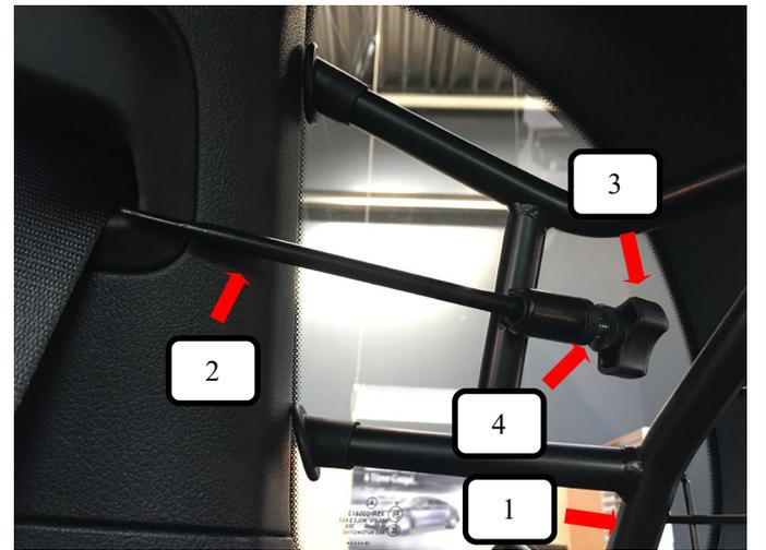
Trenngitter (Pos. 1) von hinten aus schräg in das Fahrzeug einbringen und hinter der C-Säule platzieren. Gewindehaken (Pos. 2) in den Gurtauswurf in der C-Säule einhängen und durch das Trenngitter (Pos. 1) sowie Kunststoffhülse (Pos. 4) führen. Jetzt die Rändelmutter flach (Pos. 3) aufschrauben und festziehen.
