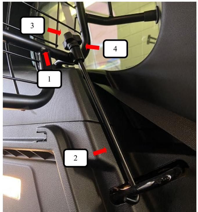
Trenngitter (Pos. 1) von hinten aus schräg in das Fahrzeug einbringen und hinter der C-Säule platzieren. Den Gewindehaken (Pos. 2) in die Rücksitzbankverankerung einhängen und durch das Trenngitter (Pos. 1) sowie Kunststoffhülse (Pos. 4) schieben. Jetzt die Rändelmutter gewölbt (Pos. 3) aufschrauben und festziehen.
