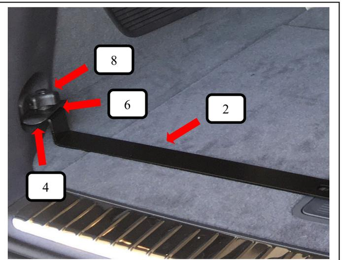
Bodenhalter (Pos. 2) von unten mit dem Gewinde durch die Verzurröse führen, von oben die Gegenplatte (Pos. 4), sowie Unterlegscheibe (Pos. 6) über das Gewinde führen und mit einer Rändelmutter flach (Pos. 8) aufschrauben und festziehen.
