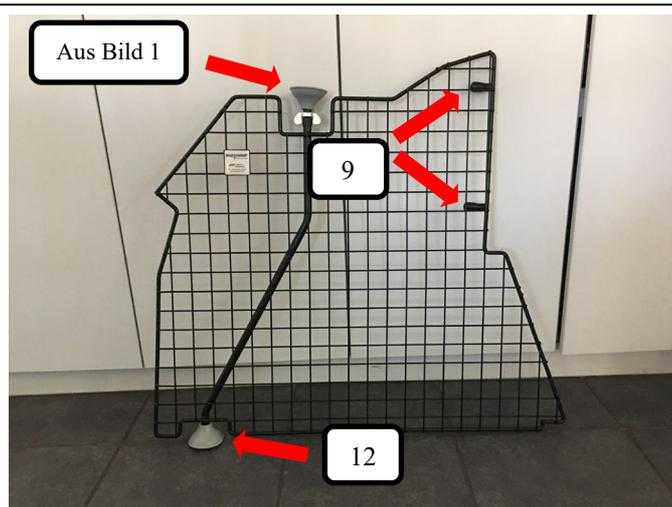
Wie im Bild dargestellt bitte die aus Bild 1 zusammengesteckte Gewindestange mit Gummifuß oben in die Rohröffnung des Teilers stecken (Feststellpunkt) und einen Gummifuß (Pos.12) unten am Teiler aufstecken. Beide Rohrendkappen (Pos. 9) auf den Teiler (Pos. 1) drücken.
