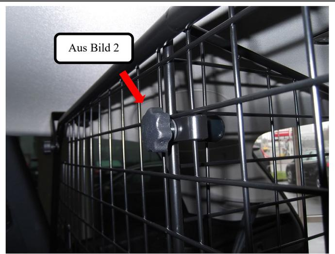
Den Teiler (Pos. 1) mittels der beiden Verschraubungen aus Bild 2 oben und unten am Trenngitter befestigen.
