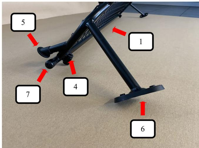
Gummiauflage groß (Pos. 6), Rohrendkappe 16mm (Pos. 7), Gummifuß 25° (Pos. 5) auf das Trenngitter (Pos. 1) und Kunststoffhülse (Pos. 4) in das Trenngitter (Pos. 1) stecken.
