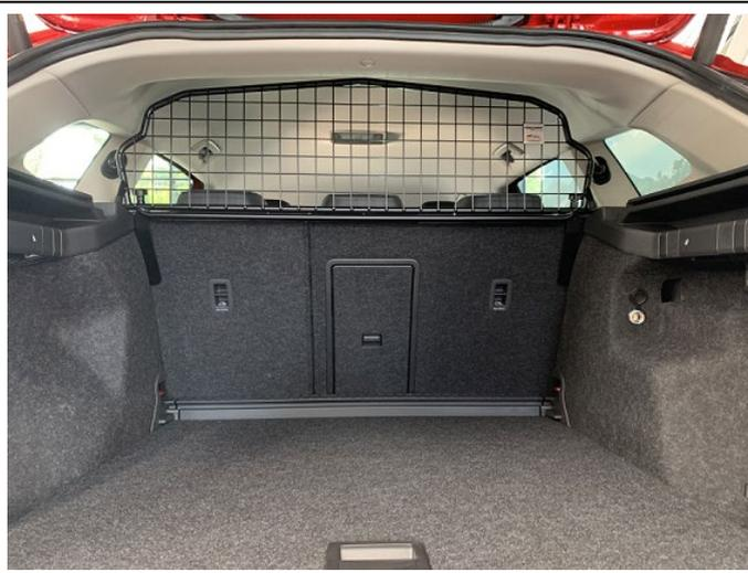
Trenngitter im montierten Zustand.
