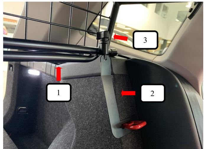
Trenngitter (Pos. 1) von hinten aus in das Fahrzeug einbringen und an der C-Säule platzieren. Gewindehaken L + R (Pos. 2) über die Rücksitzbankarretierung führen, Trenngitter (Pos. 1) leicht anheben und durch die Kunststoffhülse (Pos. 4) schieben. Jetzt die Rändelmutter gewölbt (Pos. 3) aufschrauben und spielfrei festziehen.
