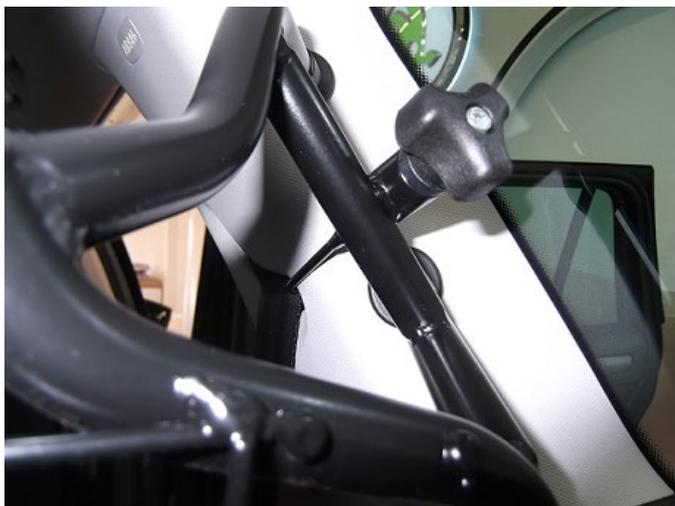
Rändelmutter gewölbt (Pos. 3) auf den Gewindehaken (Pos. 2) drehen und anziehen.
