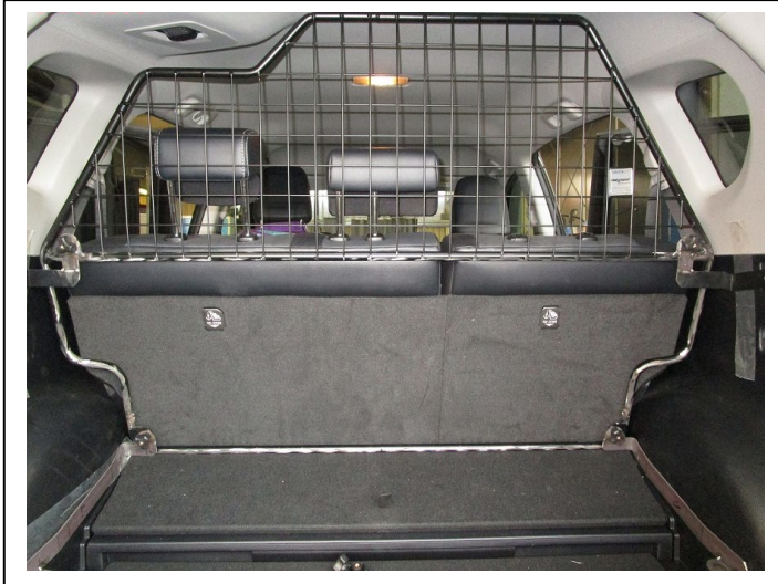
Trenngitter im montierten Zustand.
