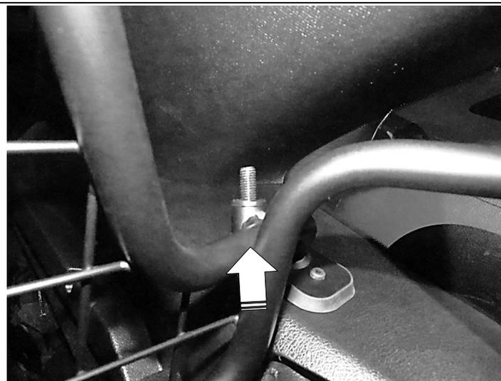
Gewindehaken durch die Hülsen am Trenngitter stecken und Öffnung der Haltekralle in die Rückenlehnen-Verankerung schieben. Zu diesem Zweck das Gitter etwas anheben.
