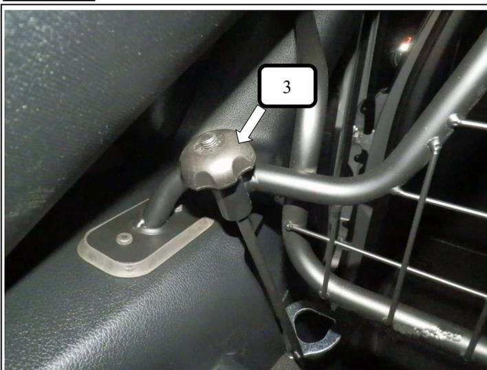
Rändelmuttern Pos.3. auf die Gewindehaken aufschrauben bis Trenngitter spielfrei sitzt. Beim zurück klappen der Rückenlehne darauf achten, dass die Gewindehaken nicht an der Rückenlehne klemmen.
