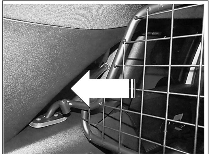
Trenngitter vom Kofferraum aus in das Fahrzeug einbringen
