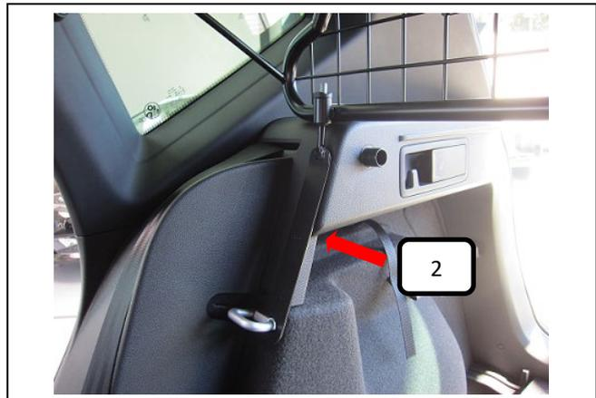
Den Gewindehaken (Pos. 2) durch das Trenngitter (Pos. 1) und Kunststoffhülse (Pos. 4) stecken.
