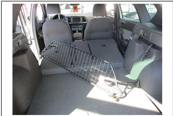
Gummiauflagen groß (Pos. 5) auf das Trenngitter (Pos. 1) und Kunststoffhülsen (Pos. 4) in das Trenngitter (Pos. 1) stecken.
