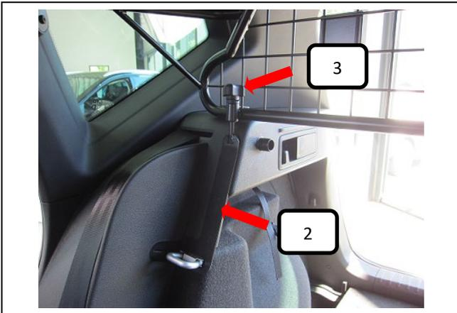
Rändelmutter gewölbt (Pos. 3) leicht auf den Gewindehaken (Pos. 2) drehen und anziehen. Wenn gewünscht, jetzt die Kofferraumabdeckung wieder einsetzen. Die Rändelmutter gewölbt (Pos. 3) jetzt festziehen.
