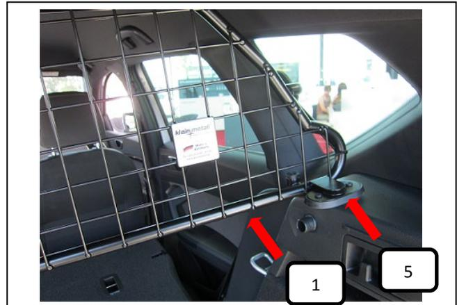
Trenngitter (Pos. 1) mit den darauf gesteckten Gummiauflagen (Pos. 5), auf den Seitenverkleidungen aufsetzen.
