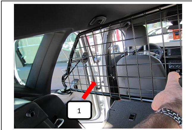
Das Trenngitter (Pos. 1) schräg von vorne nach hinten, hinter die C-Säule einführen.
