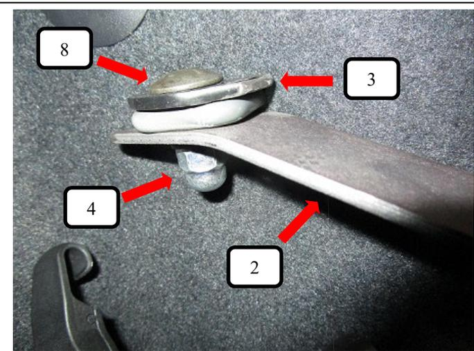
Bodenhalter (Pos. 2) von unten an die Verzurröse halten, von oben die Gegenplatte (Pos. 3) auflegen und eine Schlossschraube (Pos. 8) durchstecken. Jetzt von unten die Hutmutter (Pos. 8) aufschrauben und festziehen.
