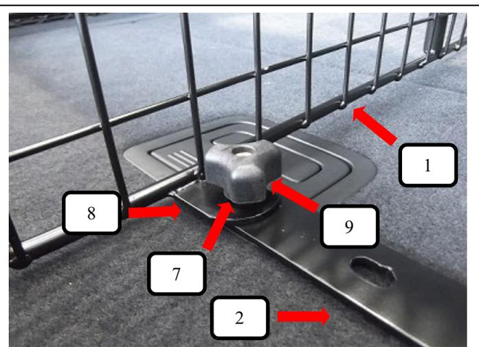
Raumteiler (Pos. 1) in das Fahrzeug einbringen. Schlossschraube (Pos. 8) von unten durch den Bodenhalter (Pos. 2) und Teiler (Pos. 1) stecken, von oben eine Unterlegscheibe (Pos. 7) und Rändelmutter flach (Pos. 9) aufschrauben und festziehen.
