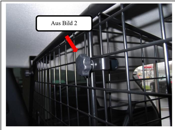
Den Raumteiler (Pos. 1) mittels der beiden Verschraubungen aus Bild 2 oben und unten am Trenngitter befestigen.
