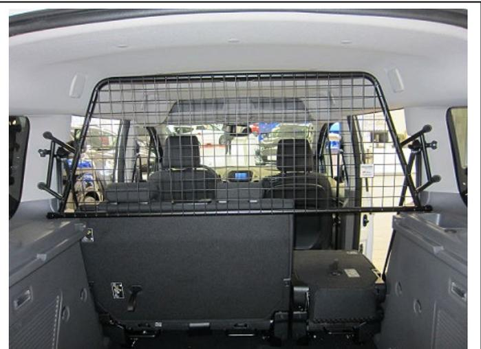
Trenngitter im montierten Zustand
