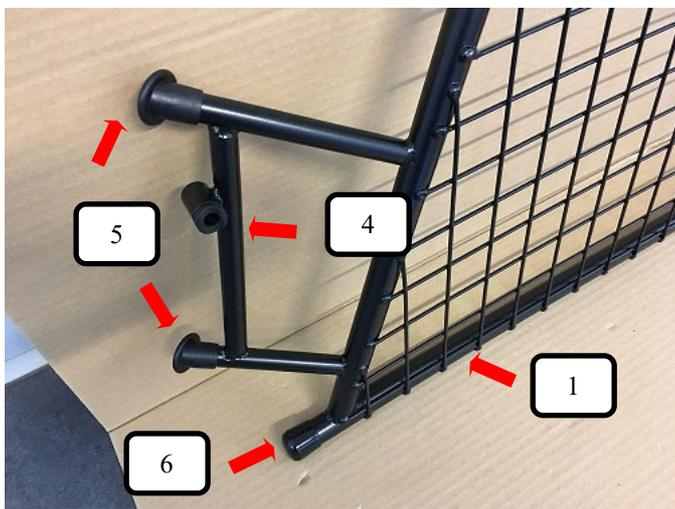
Wie auf dem Bild die Kunststoffhülse (Pos. 4) in das Trenngitter (Pos. 1) und Gummifuß 25° (Pos. 5), sowie Endkappe (Pos. 6) auf das Trenngitter (Pos. 1) stecken.
