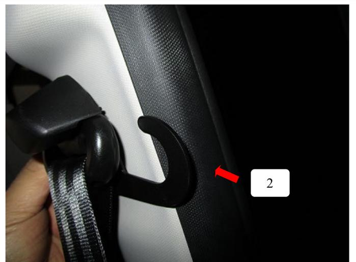
Gewindehaken (Pos. 2) an der Gurthalterung von unten einhängen.
