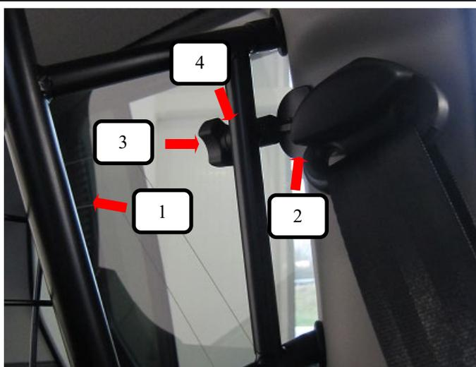
Gewindehaken (Pos. 2) durch das Trenngitter (Pos. 1) und die Kunststoffhülse (Pos. 4) stecken. Jetzt die Rändelmutter gewölbt (Pos. 3) auf den Gewindehaken (Pos. 2) aufschrauben und festziehen.
