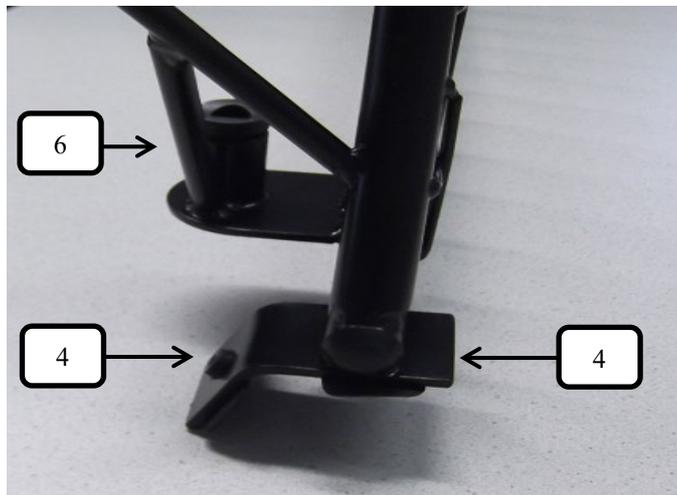
Wie dargestellt rechts und links am Trenngitter die Kunststoffhülse (Pos.6) sowie jeweils 2 Gummiauflagen klein (Pos.4) aufstecken.
