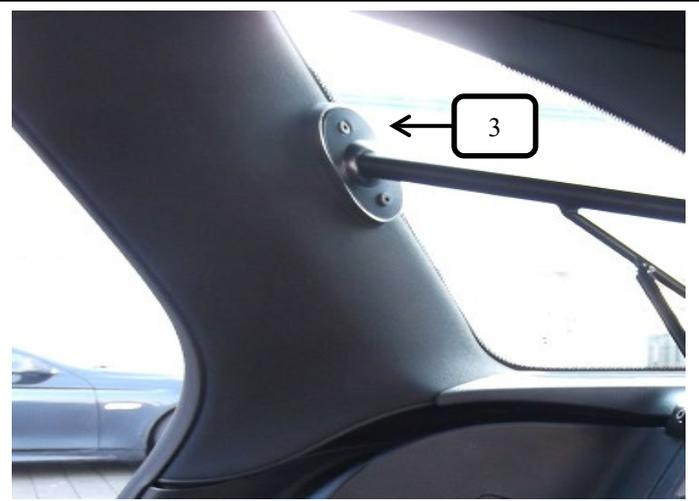
Nun rechts und links am Gitter die Gummiauflage groß (Pos.3) aufstecken.
