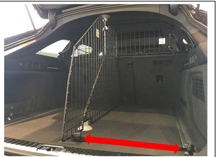
Teiler ins Fahrzeug stellen und in gewünschte Position 1/2 : 1/2 oder 1/3 : 2/3 dem Bodenhalter anpassen.
