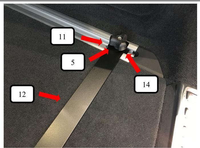
Bodenhalter (Pos. 12) über das Gewinde der Gewindeplatte (Pos. 11) stecken, jetzt eine Unterlegscheibe (Pos. 5) und Rändelmutter flach (Pos. 14) aufschrauben und festziehen.
