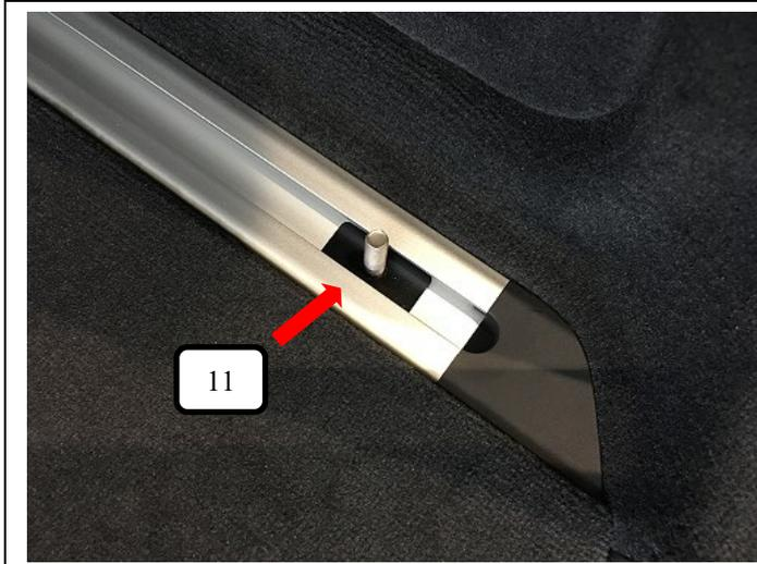
Gewindeplatte (Pos. 11) wie auf dem Bild in die Ladeschiene rechts legen.
