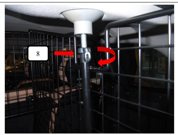
Oberen Feststellpunkt über drehen der Flügelmutter (Pos. 8) (Uhrzeigersinn) leicht anziehen.
