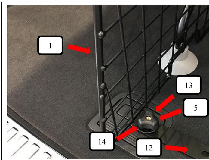
Raumteiler (Pos. 1) und Bodenhalter L+R (Pos. 12) von unten mit einer Schlossschraube (Pos. 13), Unterlegscheibe (Pos. 5) und Rändelmutter flach (Pos. 14) aufschrauben und festziehen.
