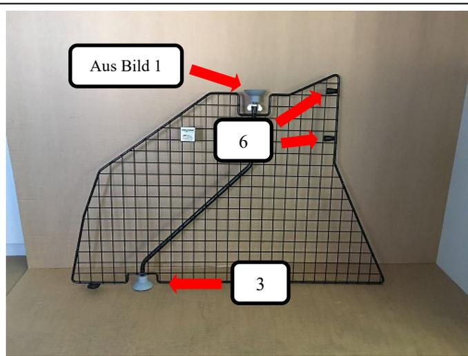
Wie im Bild dargestellt bitte die aus Bild 1 zusammengesteckte Gewindestange mit Gummifuß oben in die Rohröffnung des Teilers stecken (Feststellpunkt) und einen Gummifuß (Pos.3) unten am Teiler aufstecken. Beide Rohrendkappen (Pos. 6) auf den Teiler (Pos. 1) drücken.
