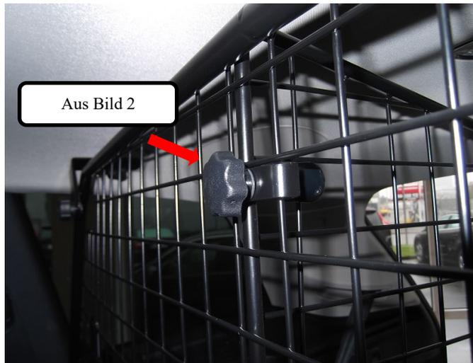
Nun den Teiler mittels der beiden Verschraubungen aus Bild 2 oben und unten am Trenngitter befestigen.
