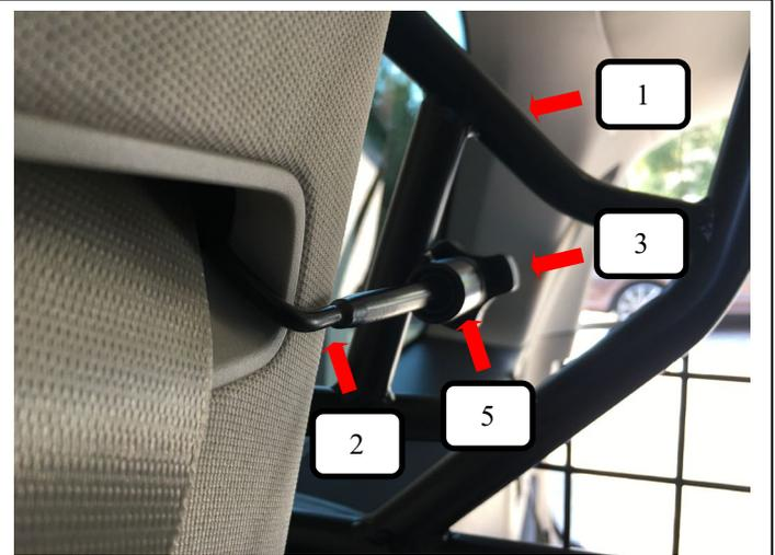
Trenngitter (Pos. 1) von hinten aus schräg in das Fahrzeug einbringen und hinter der C-Säule platzieren. Gewindehaken (Pos. 2) in den Gurtauswurf in der C-Säule einhängen und durch das Trenngitter (Pos. 1) sowie Kunststoffhülse (Pos. 5) führen. Jetzt die Rändelmutter (Pos. 3) aufschrauben und festziehen.
