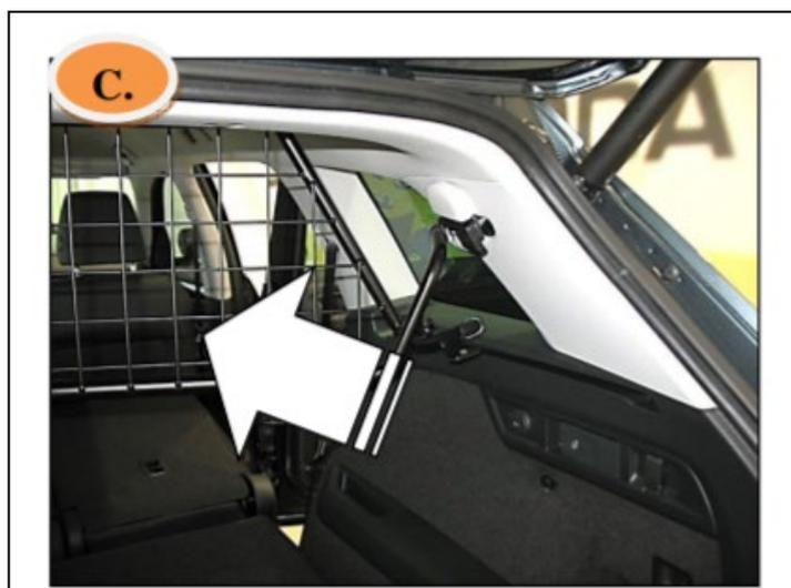
Jetzt die andere Seite des Trenngitters auch an der C-Säule positionieren.
