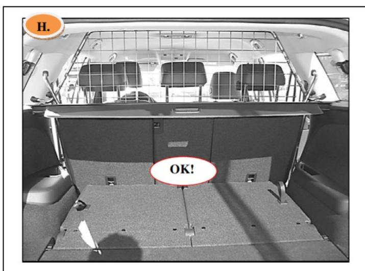
Trenngitter im montierten Zustand.
