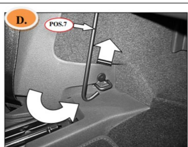
Für die Montage muss die Rücksitzbank umgelegt und nach vorne geschoben sein, da sonst die Verzurröse verdeckt ist. Gewindehaken (Pos. 7) wie auf dem Bild in die unteren Verzurrösen einhängen.
