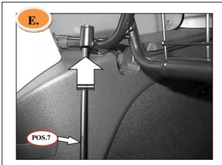
Gewindehaken (Pos. 7) wie auf dem Bild durch das Trenngitter führen.
