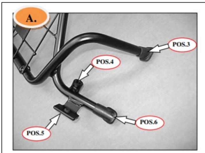
Schutzauflage klein (Pos. 5), Kunststoffhülse 25° (Pos. 3) und Kunststoffhülse 45° (Pos. 6) wie auf dem Bild auf das Trenngitter (Pos. 1) und Kunststoffhülse (Pos. 4) in das Trenngitter (Pos. 1) stecken.
