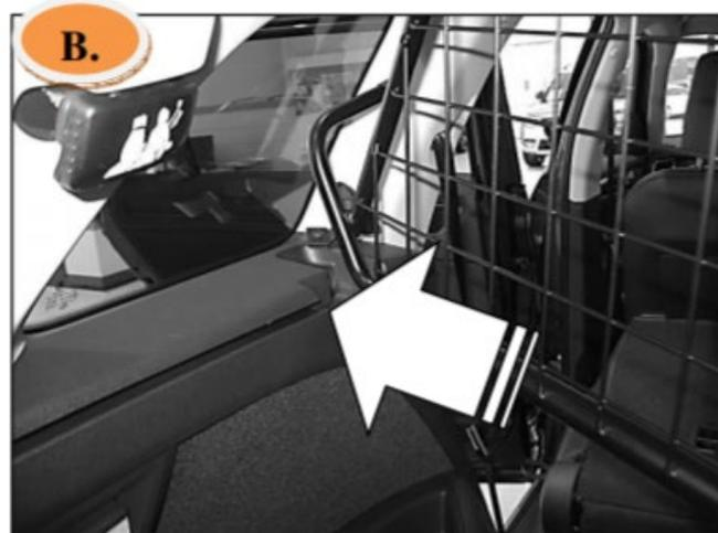
Trenngitter (Pos. 1) schräg von hinten aus in das Fahrzeug einbringen und an der C-Säule positionieren.
