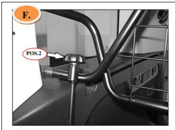
Rändelmutter (Pos. 2) aufschrauben und festziehen.
