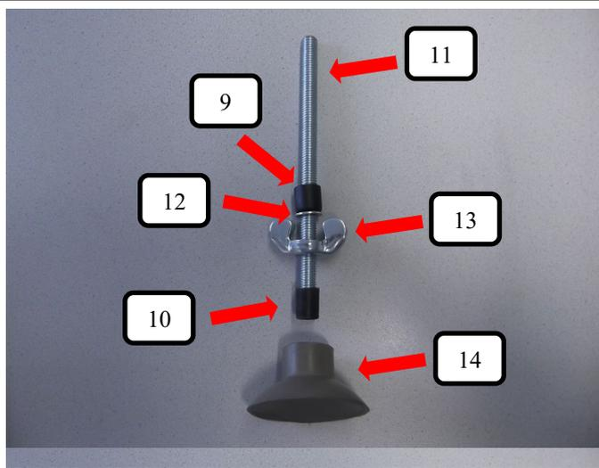
Auf die Gewindestange oben (Pos.11) die Distanzhülse (Pos. 10) und den Gummifuß grau (Pos.14) wie im Bild dargestellt aufstecken. Danach die Flügel-mutter (Pos. 13) drauf drehen und die Unterlegscheibe (Pos. 12) aufstecken.
