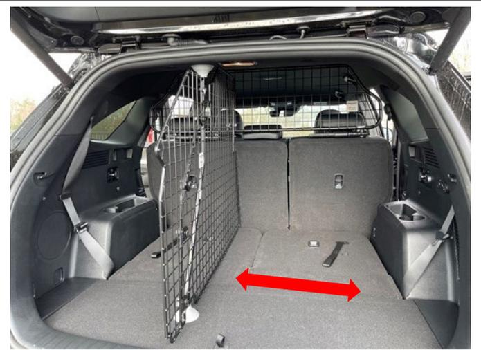
Raumteiler (Pos. 1) in das Fahrzeug einbringen.
