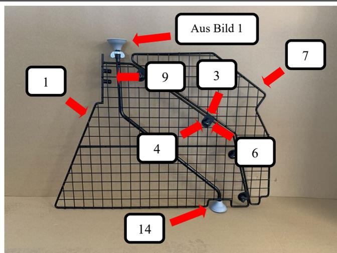
Wie im Bild dargestellt bitte die aus Bild 1 zusammengesteckte Gewindestange mit Gummifuß oben in die Rohröffnung des Teilers stecken (Feststellpunkt) und einen Gummifuß (Pos.14) unten am Teiler aufstecken. Beide Rohrendkappen (Pos. 9) auf den Teiler (Pos. 1) drücken. Teiler Adapter (Pos. 7) von oben auf den Raumteiler (Pos. 1) legen und mit jeweils eine Schloßschraube (Pos. 3), Unterlegscheibe (Pos. 6) sowie Rändelmutter flach (Pos. 4) befestigen und festziehen.
