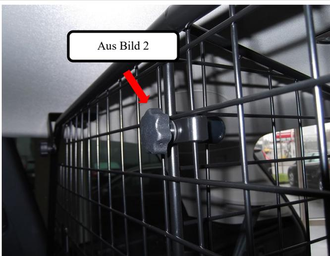
Den Raumteiler (Pos. 1) mittels der beiden Verschraubungen aus Bild 2 oben und unten am Trenngitter befestigen.
