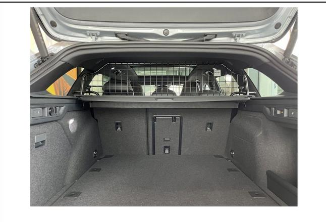
Trenngitter im montierten Zustand und eingesetztem Abdeckrollo.
