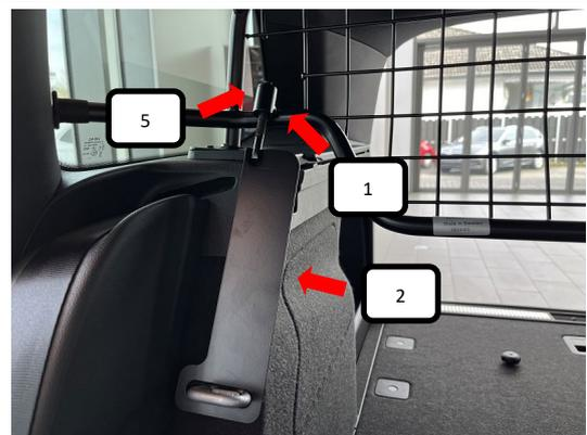
Trenngitter (Pos. 1) von hinten aus an die C-Säule führen und dort platzieren. Jetzt das Trenngitter (Pos. 1) leicht anheben und von unten den Gewindehaken L + R (Pos.2) durch die Kunststoffhülse (Pos. 5) und das Trenngitter (Pos. 1) schieben. Nun den unteren Bereich des Gewindehaken L + R (Pos. 2) über die Rücksitzbankarretierung führen.
