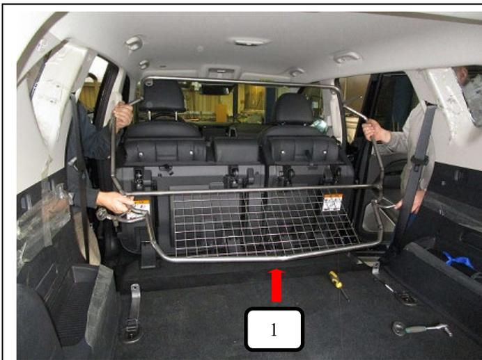
Trenngitter (Pos. 1) wie auf Bild 3 in das Fahrzeug einbringen.
