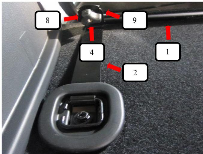
Bodenhalter (Pos. 2) mit einer Schlossschraube (Pos. 9), Unterlegscheibe (Pos. 8) und Rändelmutter flach (Pos. 4) am Trenngitter (Pos. 1) befestigen und festziehen.
