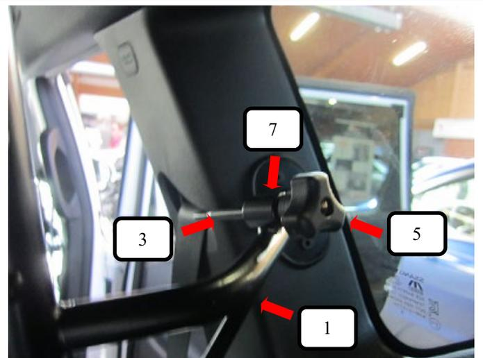
Gewindehaken (Pos.3) in die hintere Ecke der Gurtaustrittsöffnung einhängen und Gewindehaken (Pos. 3) durch die Kunststoffhülse (Pos. 7) am Trenngitter (Pos. 1) stecken. Rändelmutter gewölbt (Pos.5) aufschrauben und so lange drehen bis Trenngitter spielfrei sitzt.
