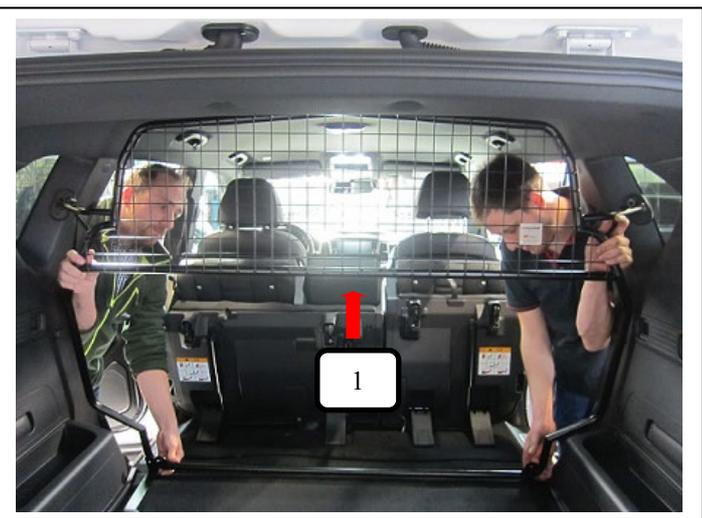
Trenngitter (Pos. 1) wie auf dem Bild 4 drehen, so dass es mit den seitlich Füßen an der C-Säule aufsteht.
