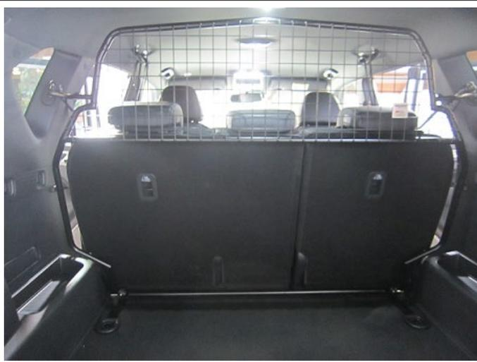
Trenngitter im montierten Zustand.
