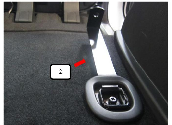
Verzurröse mit einem Kreuzschraubendreher herausschrauben, Bodenhalter (Pos. 2) darunter legen und die Verzurröse wieder reinschrauben.
