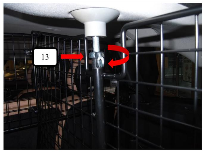
Oberen Feststellpunkt über drehen der Flügelmutter (Pos. 13) (Uhrzeigersinn) leicht anziehen.
