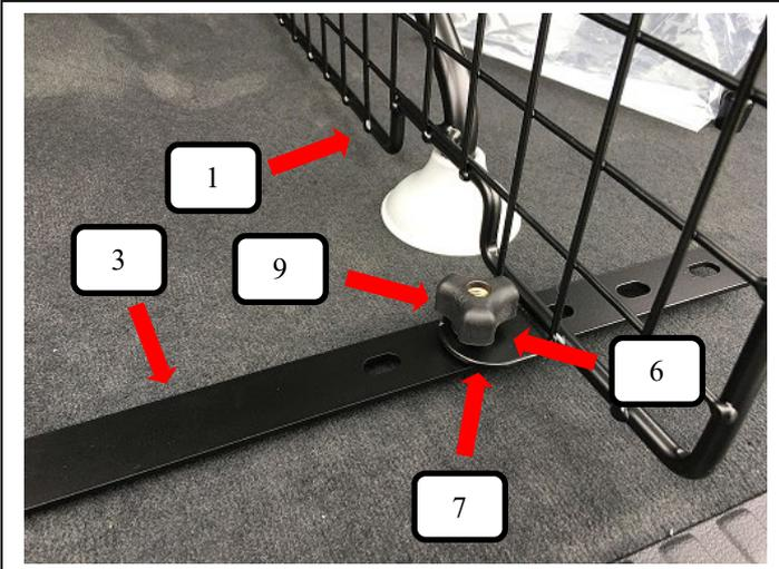
Raumteiler (Pos. 1) in die gewünschte Position in das Fahrzeug einbringen. Teiler (Pos. 1) auf den Bodenhalter mit Gewinde (Pos. 3) stellen und von unten eine Rundkopfschraube M8x20 (Pos. 7) durchstecken. Von oben eine Unterlegscheibe (Pos. 6) und Rändelmutter flach (Pos. 9) aufschrauben und festziehen.
