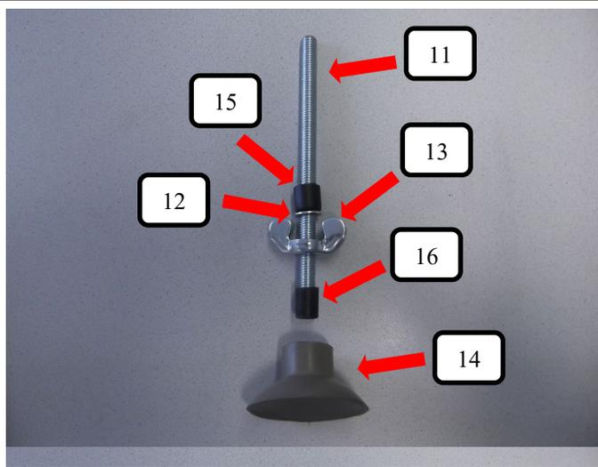
Die Gewindestange oben (Pos.11) auf einen Gummifuß grau (Pos.14) wie im Bild dargestellt aufstecken. Danach die Flügelmutter (Pos. 13) drauf drehen und die U-Scheibe (Pos. 12), sowie die Distanzhülse (Pos. 15) aufstecken.
