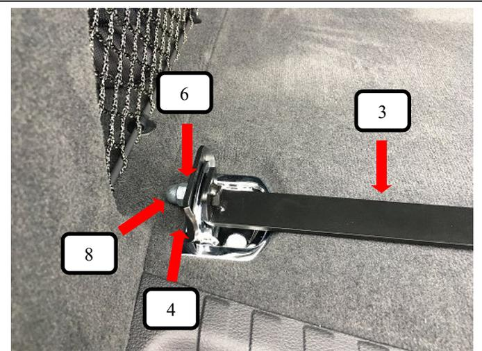
Verzurröse aufrecht stellen, Bodenhalter mit Gewinde (Pos.3) wie auf dem Bild mit dem Gewinde durch die Verzurröse schieben. Jetzt von der anderen Seite die Gegenplatte (Pos. 4), Unterlegscheibe (Pos. 6) und Hutmutter (Pos. 8) aufschrauben und festziehen.
