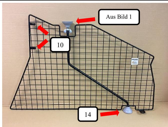
Wie im Bild dargestellt bitte die aus Bild 1 zusammengesteckte Gewindestange mit Gummifuß oben in die Rohröffnung des Teilers stecken (Feststellpunkt) und einen Gummifuß (Pos.8) unten am Teiler aufstecken. Beide Rohrendkappen (Pos. 10) auf den Teiler (Pos. 1) drücken.
