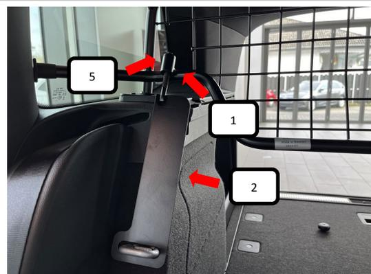
Trenngitter (Pos. 1) von hinten aus an die C-Säule führen und dort platzieren. Jetzt das Trenngitter (Pos. 1) leicht anheben und von unten den Gewindehaken L + R (Pos.2) durch die Kunststoffhülse (Pos. 5) und das Trenngitter (Pos. 1) schieben. Nun den unteren Bereich des Gewindehaken L + R (Pos. 2) über die Rücksitzbankkarreterierung führen.
