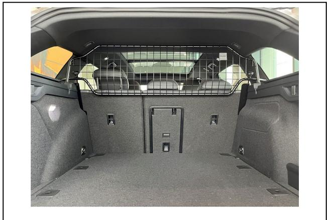
Trenngitter im montierten Zustand.
