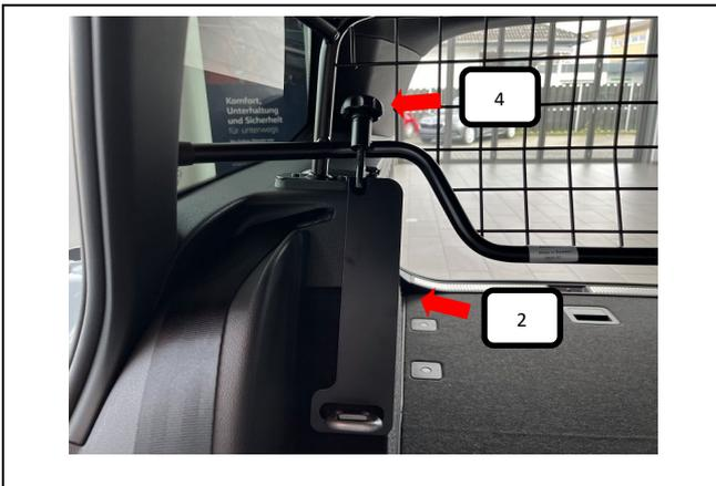
Jetzt die Rändelmutter gewölbt (Pos. 4) auf den Gewindehaken L + R (Pos. 2) aufschrauben und festziehen.
