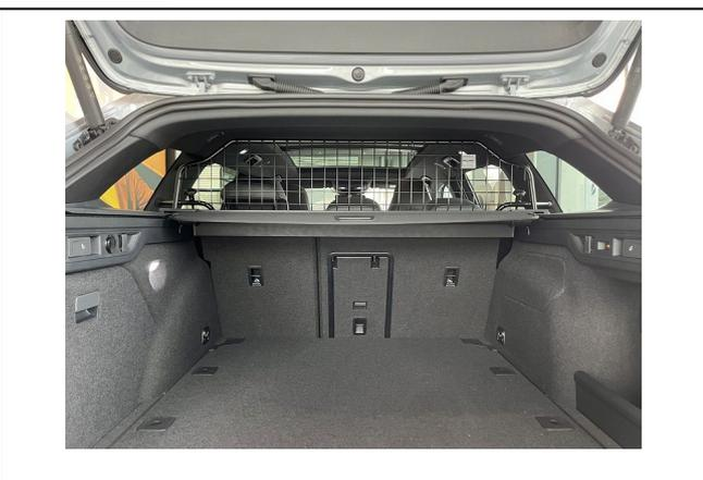
Trenngitter im montierten Zustand und eingesetztem Abdeckrollo.
