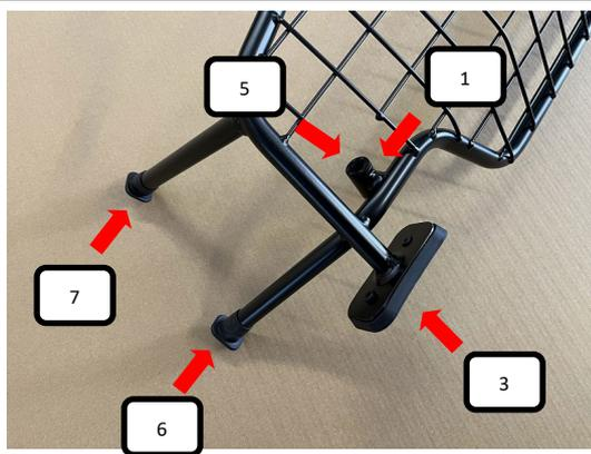
Kunststoffhülse (Pos. 5) in das Trenngitter (Pos. 1) und Gummiauflage groß (Pos. 3), Gummifuß gerade (Pos. 6) sowie Gummifuß 25° (Pos. 7) in das Trenngitter (Pos. 1) stecken.
