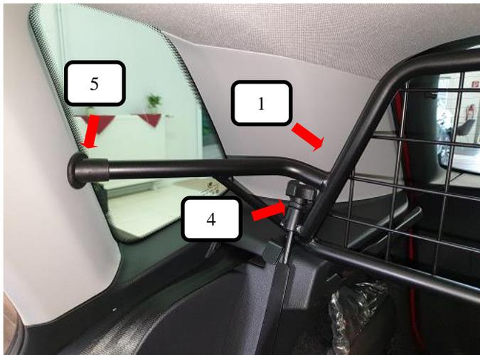
Gummifuß 25° (Pos. 5) aus das und Kunststoffhülse (Pos. 4) in das Trenngitter (Pos. 1) stecken, jetzt das Trenngitter (Pos. 1) in das Fahrzeug von hinten einbringen.
