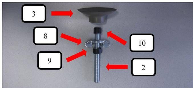
Die Gewindestange oben (Pos.2) auf einen Gummifuß grau (Pos.3) wie im Bild dargestellt auf stecken. Danach die Flügelmutter (Pos. 8) drauf drehen und die Unterlegscheibe (Pos. 9), sowie die Distanzhülse (Pos. 10) aufstecken.
