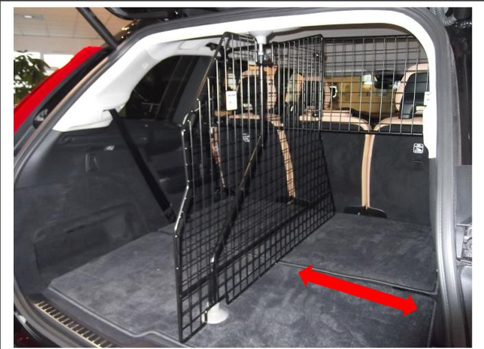
Teiler ggf. leicht ausrichten und final befestigen.
