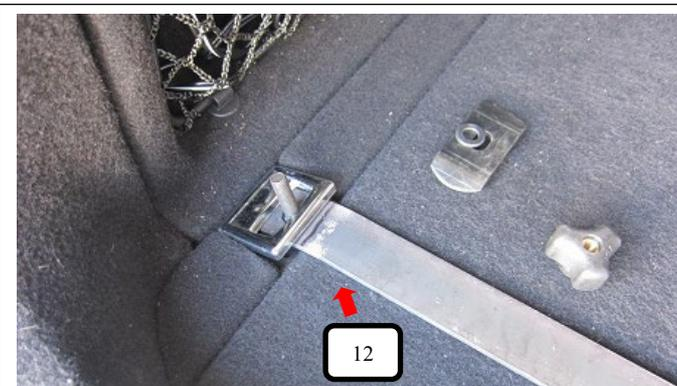
Bodenhalter mit angeschweißter M8x30 (Pos. 12) von unten durch die Verzurröse stecken.
