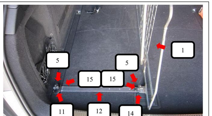
Bodenhalter (Pos. 12) mit einer Gegenplatte (11), Unterlegscheibe (Pos. 5) und Rändelmutter flach (Pos. 15) an der Verzurröse aufschrauben und festziehen. Jetzt den Bodenhalter (Pos. 12) mit der Schlossschraube (Pos. 14), Unterlegscheibe (Pos. 5) und Rändelmutter flach (Pos. 15) am Raumteiler (Pos. 1) aufschrauben und festziehen.
