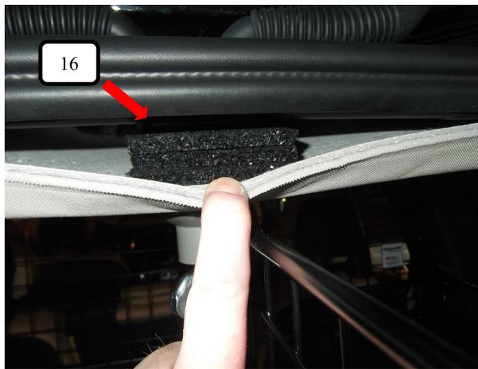
Im oberen Bereich der Hecktür die Gummiabdichtung leicht anheben und je nach gewünschter Position des Teilers die Gummimunterlagen 8mm (Pos.16) im Bereich des Feststellpunktes in den Hohlraum schieben.
