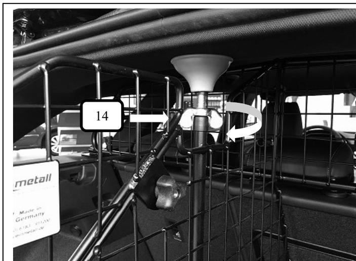
Oberen Feststellunkt mittel drehen der Flügelmutter (Pos. 14) (Uhrzeigersinn) leicht anziehen.
