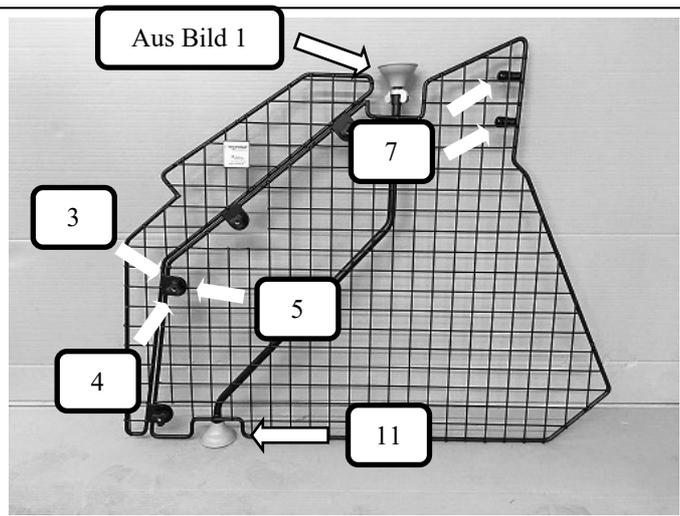
Wie im Bild dargestellt die aus Bild 1 zusammengesteckte Gewindestange mit Gummifuß oben in die Rohröffnung des Teilers stecken (Feststellpunkt) und einen Gummifuß (Pos.11) unten am Teiler aufstecken. Beide Rohrendkappen (Pos. 7) auf den Teiler (Pos. 1) drücken. Den Adapter-Teiler (Pos. 15) an allen vier Punkten mit einer Schlossschraube (Pos. 3), Unterlegscheibe (Pos. 5) und Rändelmutter flach (Pos. 4) wie auf dem Bild befestigen.
