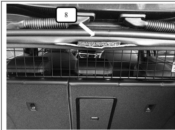
Im oberen Bereich der Hecktür die Gummiabdichtung leicht anheben und je nach gewünschter Position des Teilers die Gummimunterlagen 8mm (Pos.8) im Bereich des Feststellpunktes in den Hohlraum schieben.
