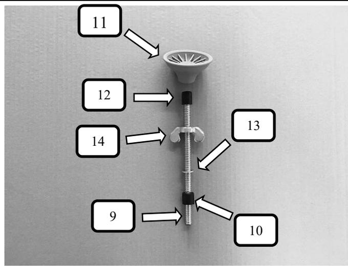
Die Gewindestange oben (Pos.9) mit der Distanzhülse (Pos. 12), in den Gummifuß grau (Pos.11) wie im Bild dargestellt aufstecken. Danach die Flügelmutter (Pos. 14) aufschrauben und die Unterlegscheibe (Pos. 13), sowie die Durchführungsschutzkappe (Pos. 10) aufstecken.
