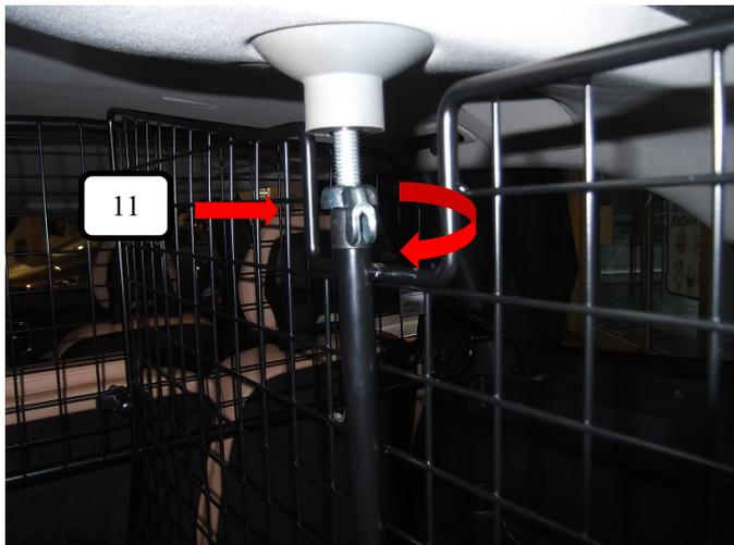
Oberen Feststellpunkt über drehen der Flügelmutter (Pos. 11) (Uhrzeigersinn) leicht anziehen.
