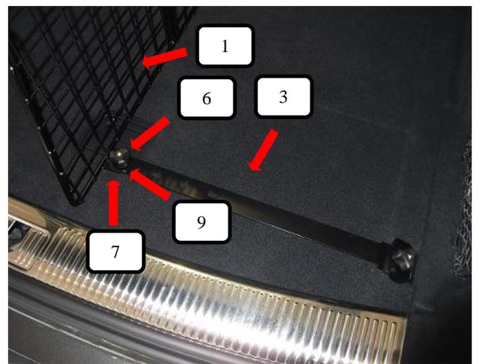
Auf der anderen Seite des Bodenhalters (Pos. 3), von unten die Schlossschraube (Pos. 7) an gewünschter Position durchstecken, jetzt den Teiler (Pos. 1) darüber stellen und von oben mit der Unterlegscheibe (Pos. 6) sowie Rändelmutter flach (Pos. 9) festziehen.
